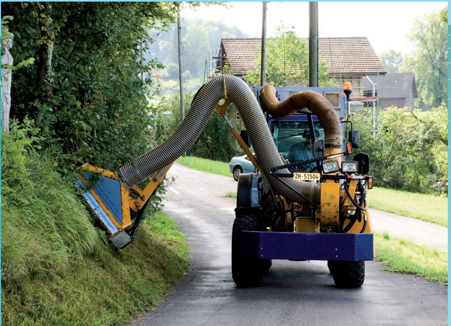
Mulchen einer Böschung mit direktem Absaugen ▲
